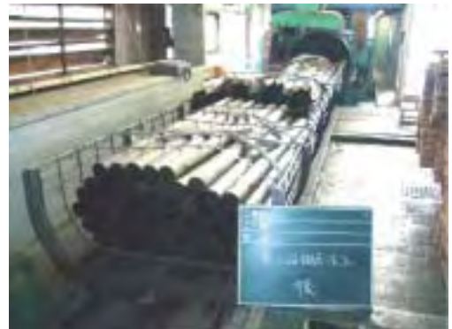
防腐加工 注入後（外注）
