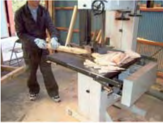
先付け（杭）加工
